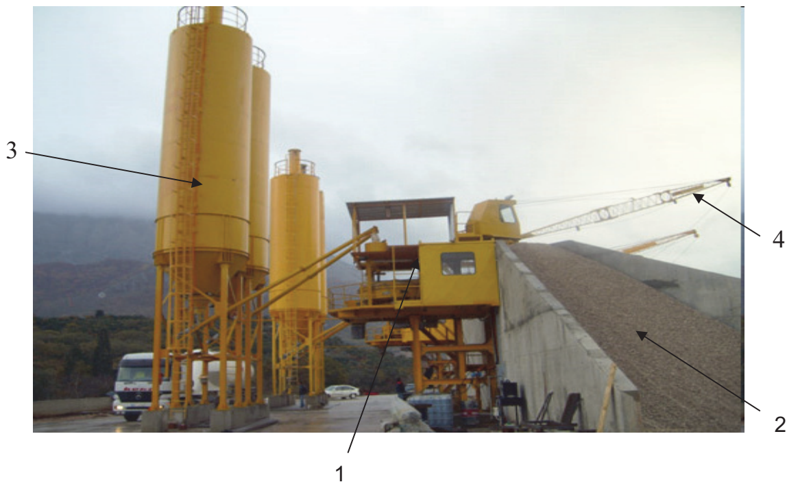
Fig. 5.27. Fabrika për beton: 1. Pjesa makinerike, 2. agregati, 3. Siloset për çimento dhe 4. ekskavatori me lugë tërheqëse.
